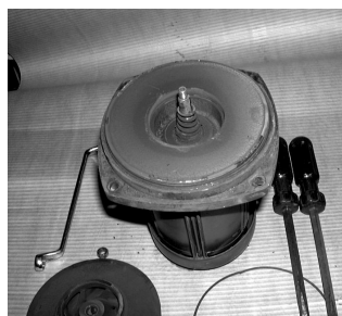
Alkutilanne. Käyttöyksikkö juoksupyörä irrotettuna:
