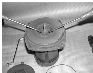
1) Irrota akselitiiviste kahta ruuvitalttaa apuna käyttäen. Älä vahingoita akselin tiivistepintaa.
